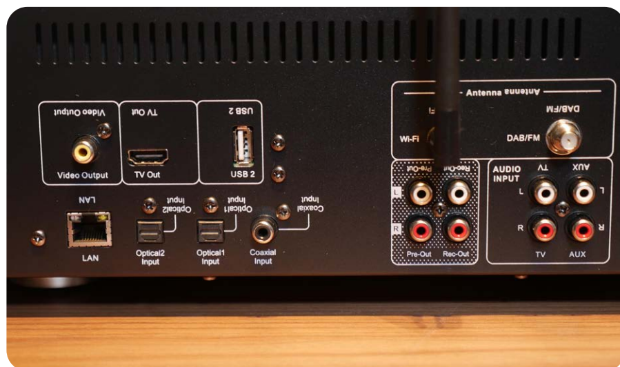
Umfangreiche Anschlussvielfalt für analoge und digitale Quellen, sowie ein HDMI-Ausgang für den Anschluss an den Fernseher. Praktisch: Für den einfachen Anschluss der Kabel sind Beschriftungen auch „über Kopf“ angebracht
